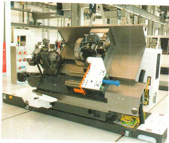
Рис.1 Компоновка станка DMG Mori. Показать расположение станины, шпиндельной бабки, револьверной головки, направляющих, задней бабки
