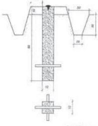
Рис. 1 Бетонный лоток
