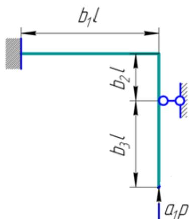
**Задача № 2.** Проверить на устойчивость сжатый стержень заданного сечения из легированной стали 30 ГСА (ее механические характеристики: предел пропорциональности  $\sigma_{\text{пр}} = 700$  МПа; предел текучести  $\sigma_{0,2} = 850$  МПа; модуль продольной упругости  $E = 2,1 \cdot 10^5$  МПа).
