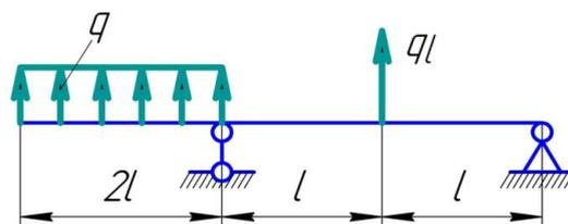
**Задача №2.** Определить для стальной двухопорной балки необходимый размер  $b$  прямоугольного поперечного сечения с заданным соотношением сторон.
