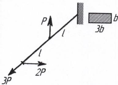
Определить необходимый диаметр  $d$  стальной консольной балки круглого сечения при заданных  $P$ ,  $l$ ,  $[\sigma]$ . Решение представить в общем виде.
