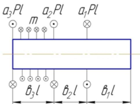
Для стержня, испытывающего кручение, и находящегося в равновесии, найти из условия равновесия величину интенсивности равномерно распределенного скручающего момента  $m$  и построить эпюру крутящего момента.
