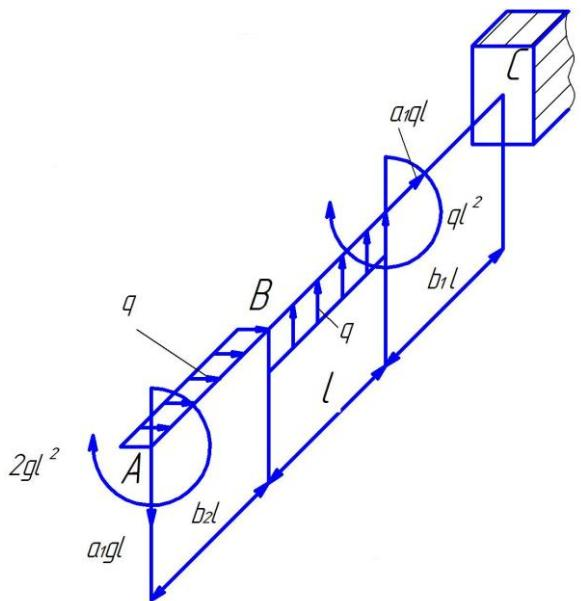
Для прямого бруса необходимо выполнить проверочный расчет на прочность, используя третью теорию прочности (теорию наибольших касательных напряжений). На участке АВ брус имеет круглое сплошное поперечное сечение диаметром  $d$ , на участке ВС – прямоугольное с соотношением сторон  $h/b=2$ . Допускаемое напряжение  $[\sigma]=160$  МПа, длина  $l=1$  м.
