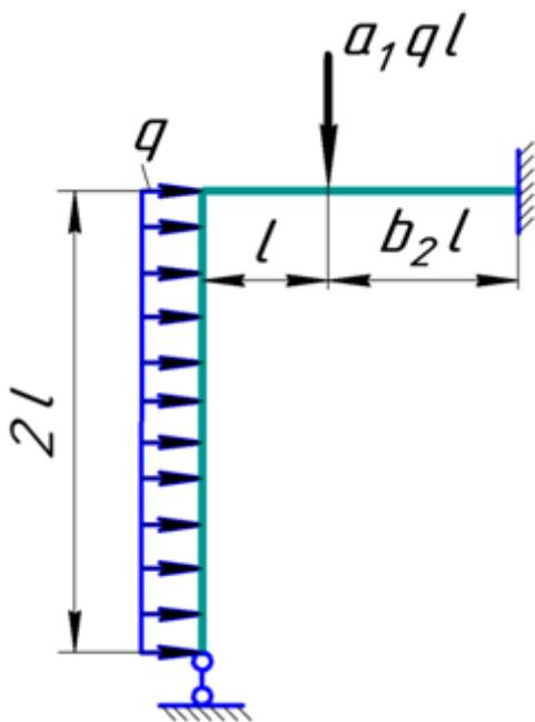
Для плоской статически неопределенной рамы требуется раскрыть с помощью метода сил ее неопределенность, построить эпюры всех внутренних силовых факторов, выполнить капитальную проверку правильности раскрытия статической неопределенности и подобрать согласно заданию (см. таблицу, столбец 6) номер двутавра (ГОСТ 8239-89) или швеллера ГОСТ (8240-89). При необходимости использовать несколько одинаковых профилей.
