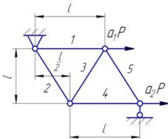
Выполнить проектировочный расчет на прочность (определить площади поперечных сечений стержней  $F_i$ ) стержневой системы, если известны: сила  $P = 70$  кН; предел текучести материала стержней  $\sigma_T = 270$  МПа; нормативный коэффициент запаса прочности по отношению к пределу текучести  $n_T = 1,5$ .
