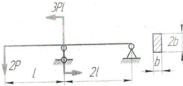
**Задача №3.** Определить грузоподъемность (величину допускаемой нагрузки  $[P]$ ) стальной консольной балки квадратного сечения. При найденной величине допускаемой силы вычислить прогиб среднего сечения консоли.
