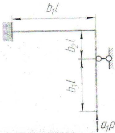
**Задача № 2.** Проверить на устойчивость сжатый стержень заданного сечения из легированной стали 30 ГСА (ее механические характеристики: предел пропорциональности  $\sigma_{pu} = 700$  МПа; предел текучести  $\sigma_{0,2} = 850$  МПа; модуль продольной упругости  $E = 2,1 \cdot 10^5$  МПа).
