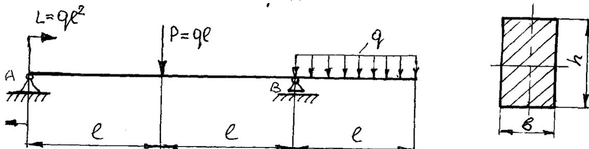
Двухопорная балка нагружена по представленной расчетной схеме. Построить эпюры поперечных сил и изгибающих моментов и выполнить проектировочный расчет на прочность. Материал балки сталь, предел текучести
