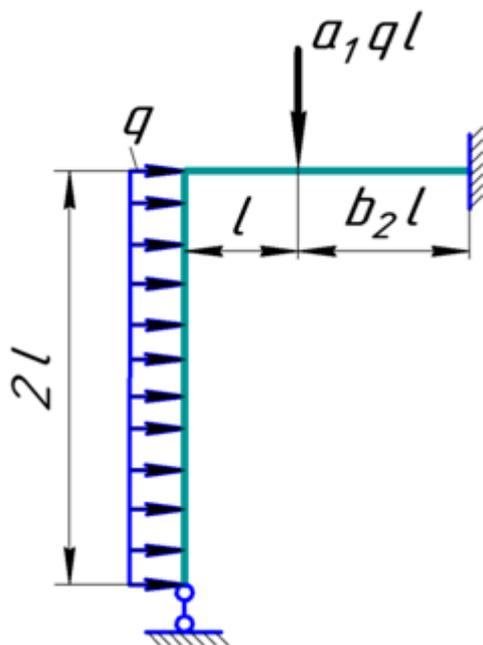
Принять допускаемое напряжение  $[\sigma]=160$  МПа, длину  $l=1$  м. Жёсткость сечения стержней рамы постоянна. Численные значения интенсивности распределенной
