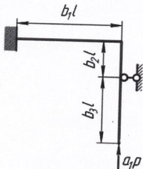
**Задача № 2.** Проверить на устойчивость сжатый стержень заданного сечения из легированной стали 30 ГСА (ее механические характеристики: предел пропорциональности  $\sigma_{us} = 700$  МПа; предел текучести  $\sigma_{0,2} = 850$  МПа; модуль продольной упругости  $E = 2,1 \cdot 10^5$  МПа).
