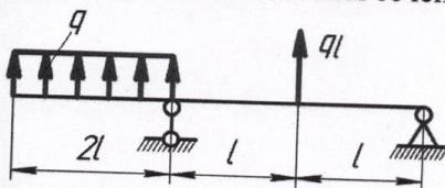
**Задача №2.** Определить для стальной двухпорной балки необходимый размер  $b$  прямоугольного поперечного сечения с заданным соотношением сторон.
