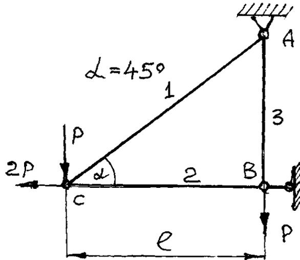
Выполнить проектировочный расчет на прочность (определить необходимые площади поперечных сечений стержней) стержневой системы представленной на расчетной схеме.
