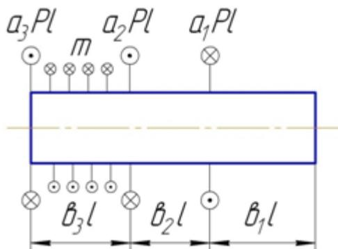
Для стержня, испытывающего кручение, и находящегося в равновесии, найти из условия равновесия величину интенсивности равномерно распределенного скручивающего момента  $m$  и построить эпюру крутящего момента.
