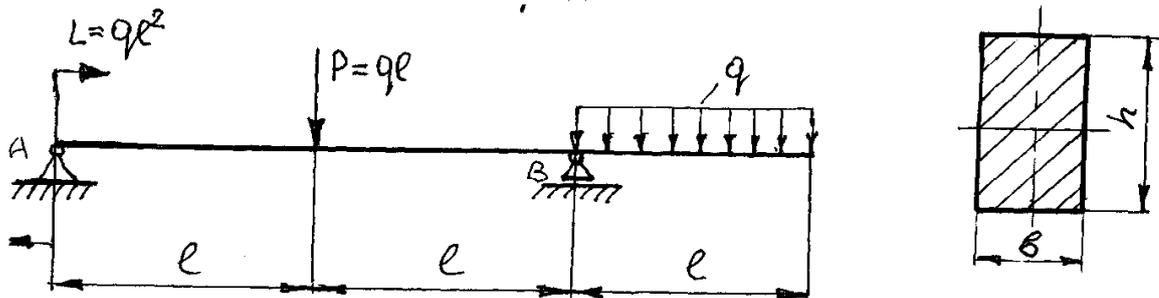
Двухопорная балка нагружена по представленной расчетной схеме. Построить эпюры поперечных сил и изгибающих моментов и выполнить проектировочный расчет на прочность. Материал балки сталь, предел текучести материала  $\sigma_T = 300$  МПа, коэффициент запаса прочности  $n_T=2$ ,  $l=1$ м,  $q=20$  кН/м. Поперечное сечение балки прямоугольное ( $h=2b$ ).
