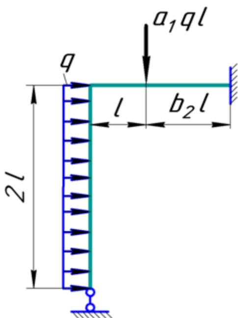
Для плоской *статически неопределимой* рамы требуется раскрыть с помощью метода сил ее неопределимость, построить эпюры всех внутренних силовых факторов, выполнить капитальную проверку правильности раскрытия статической неопределимости и *подобрать* согласно заданию (см. таблицу, столбец б) номер двутавра (ГОСТ 8239-89) или швеллера ГОСТ (8240-89). При необходимости использовать несколько одинаковых профилей.
