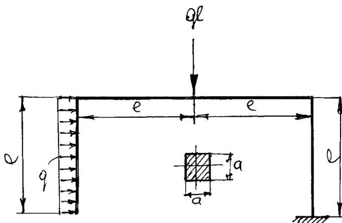
Выполнить проверочный расчет на прочность плоской рамы. Влиянием поперечной силы пренебречь. Поперечное сечение стержней квадратное  $a \times a$  ( $a=10$  см). Материал стержней сталь,  $[\sigma] = 160$  МПа,  $l=1$  м;  $q=10$  кН/м.
